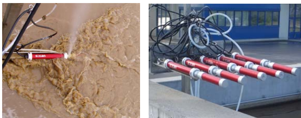
Obr. 2: Prístroj s::can nitro::lyser™ inštalovaný na Ústrednej ČOV mesta Viedeň
